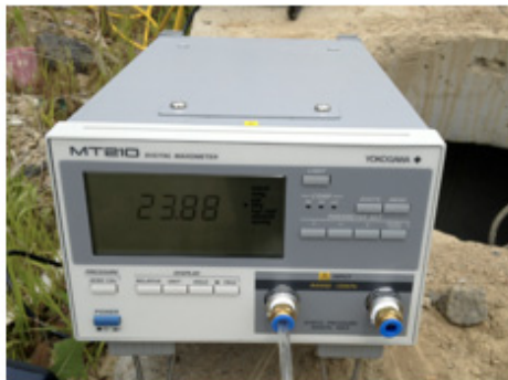
(d) micromanometer for velocity
