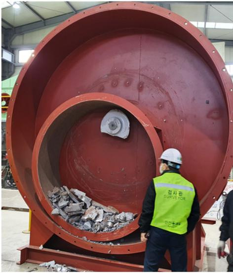
Fig. 13 Impeller breakage
